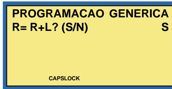
Teclando **S** para sim, para o acionamento da velocidade lenta ou teclando **N** para não, seu sistema adotará a velocidade rápida. Esta opção depende do tipo de alimentador/comporta que estiver sendo utilizada no seu sistema, em seguida, teclando
