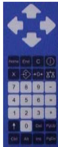
O teclado do Terminal Industrial 9600 é apresentado na parte frontal com 100 teclas. É um teclado do tipo membrana, construído com múltiplas camadas de material plástico e constitui uma unidade selada capaz de aceitar limpeza com pano úmido e sabão neutro. A membrana externa é impressa de modo indelével com as legendas correspondentes a cada função.
